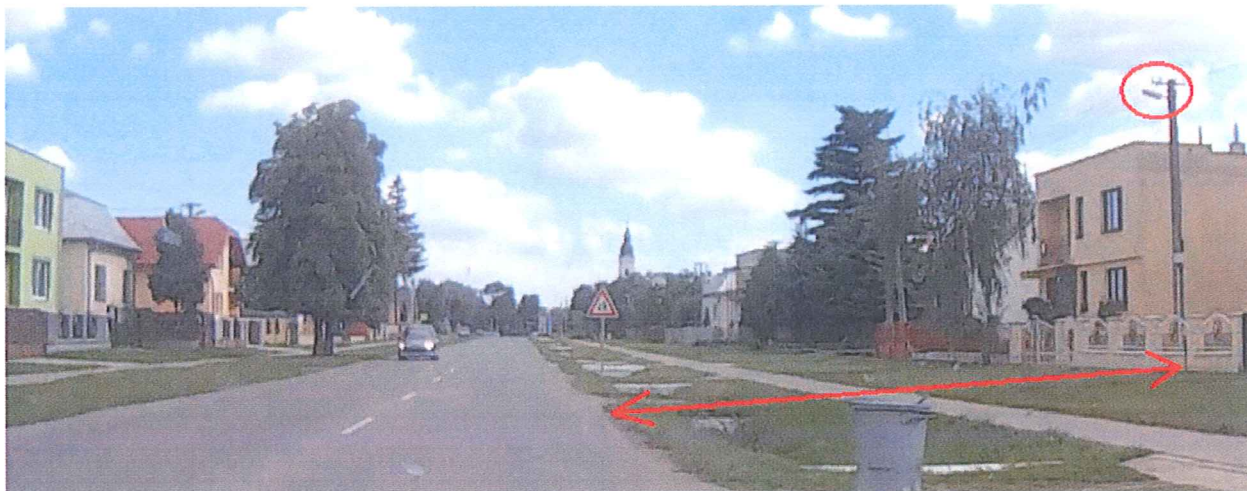
Obr. 5 Veľká vzdialenosť od osvetľovanej komunikácie
